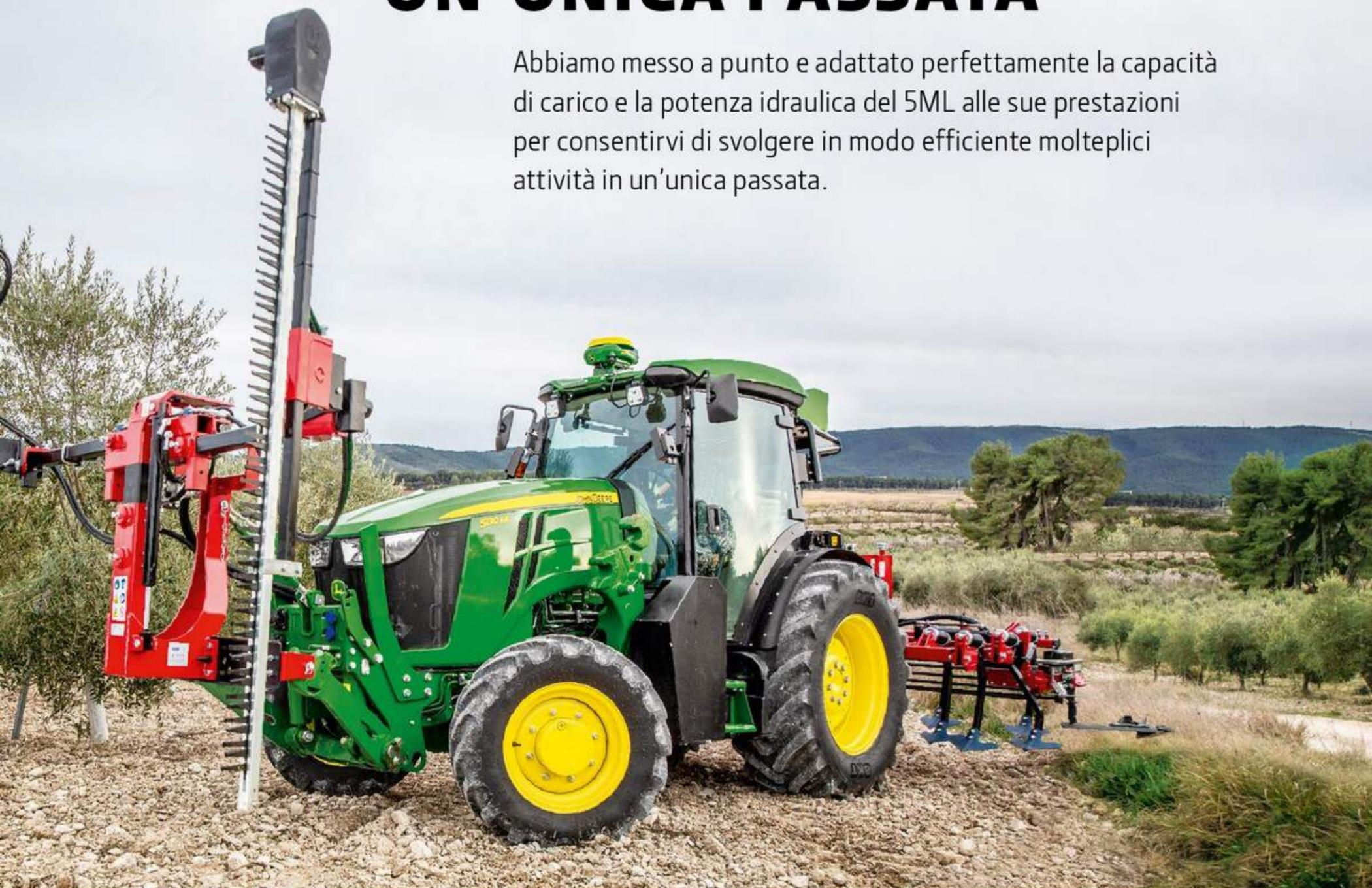
Grazie al potente flusso idraulico da 117 l/min erogato dall'impianto a controllo di flusso e pressione, il 5ML è pronto per qualsiasi attrezzatura con azionamento idraulico utilizzata nelle applicazioni nei frutteti o nelle vigne. Collegate le attrezzature che richiedono molta potenza direttamente al sistema idraulico del trattore senza pompa esterna azionata dalla PTO e realizzate molteplici attività in un'unica passata produttiva.
