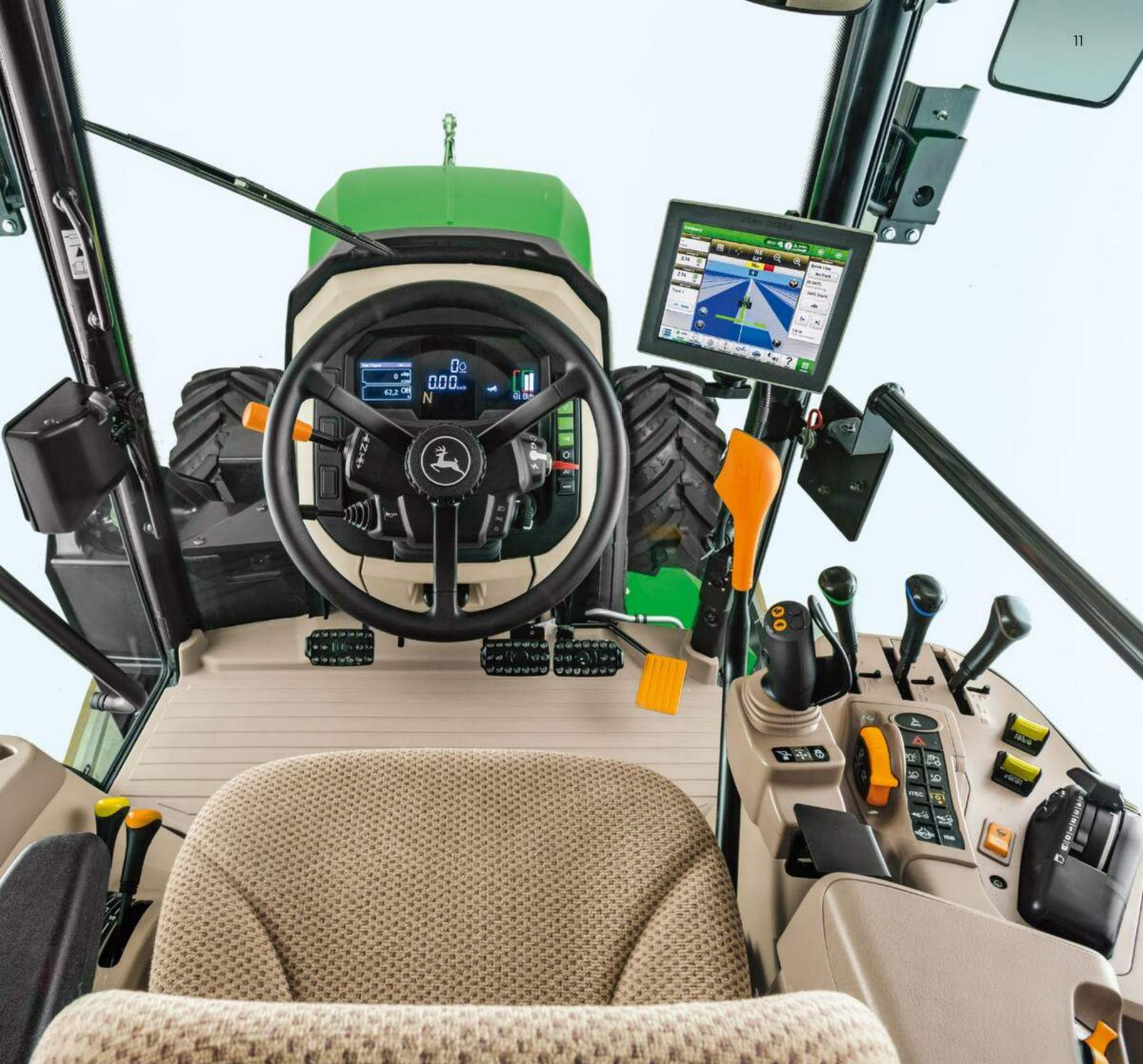
La nostra cabina Premium certificata di categoria 4 presenta un joystick elettronico e un display riconfigurabile integrato nel cruscotto per il controllo delle funzioni del trattore.
