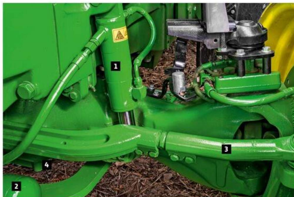
Sospensione TLS™ Plus: essere tutt'uno con la strada. I sistemi di sospensione anteriori completamente integrati e autolivellanti offrono una sensazione di sicurezza in più quando si guida su strade curve al massimo della velocità. Il nuovo sistema ActiveCommand Steering migliora ulteriormente le prestazioni di guida su strada del nuovo 7R. Ma la differenza si nota anche sul campo, in quanto il contatto costante con il terreno e la massima trazione sono garantiti in ogni momento.
