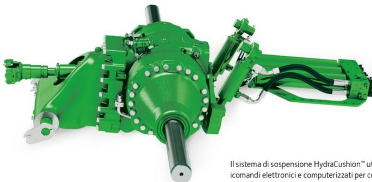
Il sistema di sospensione HydraCushion™ utilizza comandi elettronici e computerizzati per controllare le funzioni del trattore e la posizione degli assali. Sulla base di tali segnali, l'impianto elettrico attiva automaticamente le funzioni idrauliche che comandano il sollevamento, l'abbassamento o il mantenimento in posizione.
