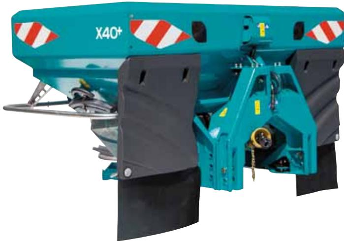
*Carter para-fango in materiale composito inalterabile (di serie) ed estensioni morbide (opzione) :una protezione totale contro le proiezioni di terra al momento dello spandimento ad alta velocità in condizione umide ed una pulizia facilitata.*
